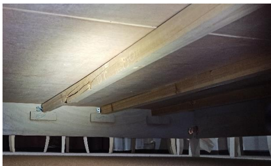
Рисунок 3 - Глубокая трещина царги кровати
